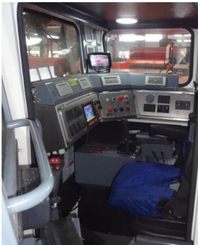
Внутренняя часть закрытой кабины оклеена огнестойкой шумопоглощающей тканью толщиной 25 мм, которая не только красива и удобна, но также эффективна для снижения уровня пыли и шума. Применяются стеклопакеты, при установке используются четырехпортовые уплотнительные ленты. Стекло можно разбирать как внутри, так и снаружи, что используется для аварийного выхода при возникновении опасной ситуации. Кабина и рама закреплены резиновыми амортизаторами для уменьшения вибрации кабины..
